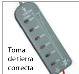
Si se encienden más de 2 luces del tester, deberemos revisar las conexiones de la toma de tierra y si fuera necesario instalar más picas de toma de tierra unidas entre sí, hasta que el tester no detecte tensión en la toma de tierra.
